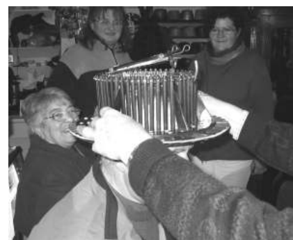
Der „Konformateur“. Nur durch ihn ist es möglich, einen bequemen Hut, den man somit auch gerne trägt, zu bekommen.
