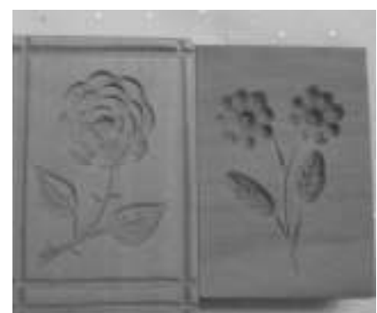
links: zweiteiliger Model unten: links handgeschnittener und rechts maschinell hergestellter Model
